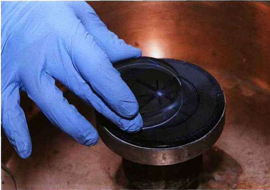
Figure 2. Le polissage avec un support en poix est exclusivement employé en optique de précision.
