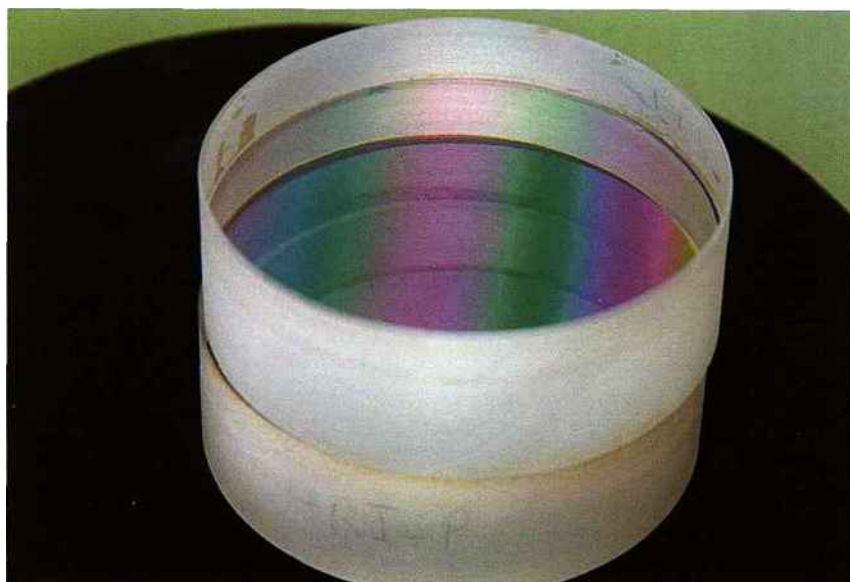
Figure 3. L'observation des franges d'interférence permet de contrôler une surface par comparaison avec un étalon de référence
